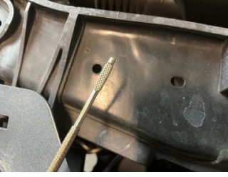
Motor, Yağ seviyesi > Eksik
