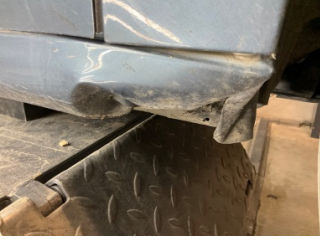
Marşbiyel, sağ, Marşbiyel, sağ > Hasarlı
