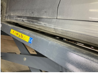
Marşbiyel, sol, Marşbiyel, sol > Hasarlı
