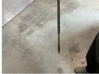
Motor, Yağ seviyesi > Eksik
