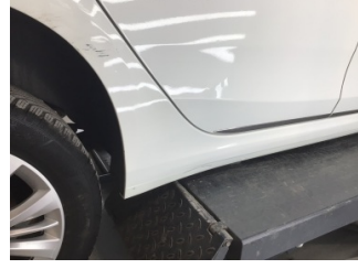
Kapı, sağ arka, Kapı, sağ arka > Ezik
