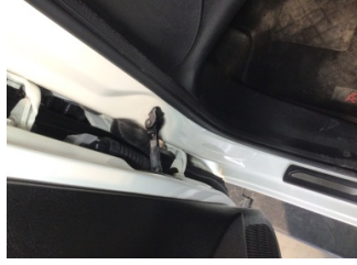
Kapı, sol ön, Kapı gergisi > Ses Yapıyor
