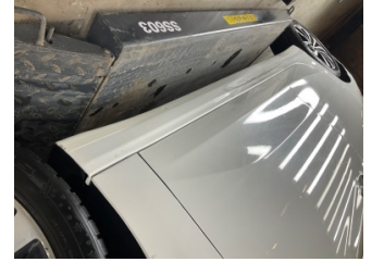
Marşbiyel, sağ, Marşbiyel, sağ > Hasarlı
