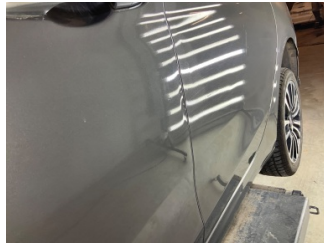
Kapı, sol ön, Kapı, sol ön > Ezik
