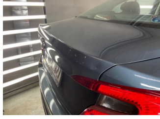
Bagaj kapağı/kapısı, Bagaj kapısı > Ezik
