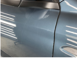
Kapı, sağ ön, Kapı, sağ ön > Çizik
