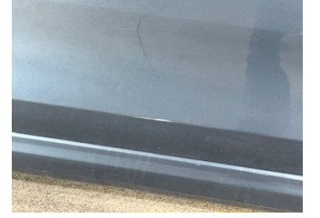
Kapı, sağ ön, Kapı, sağ ön > Çizik
