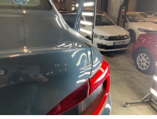
Bagaj kapağı/kapısı, Bagaj kapısı > Ezik
