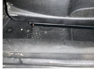
Döşemeler/Kapaklar, Döşemeler/Kapaklar > Yakıcı Madde ile Zarar Görmüş
