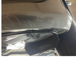
Tampon, ön, Ön tampon > Kırılmış
