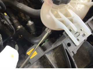
Motor, Yağ seviyesi > Eksik
