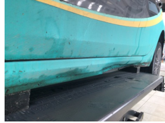
Marşbiyel, sol, Marşbiyel, sol > Hasarlı
