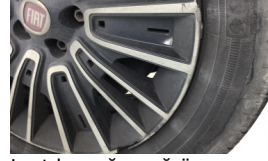
Jant kapağı, sağ ön > Hasarlı
