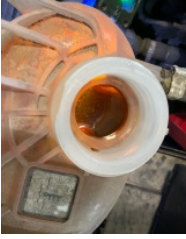
Motorsoğutması, Soğutma sıvısı > Kirlenmiş
