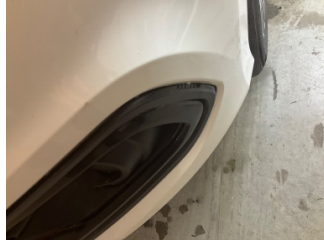
Sis lambaları, Sis Izgarası Sol > Sabitlemesi Hatalı
