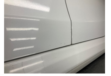
Kapı, sol ön, Kapı, sol > Ezik
