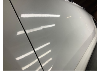
Kapı, sol ön, Kapı, sol > Ezik
