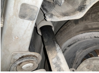
Arka aks, Amortisör, arka > Yağ Kaçağı
