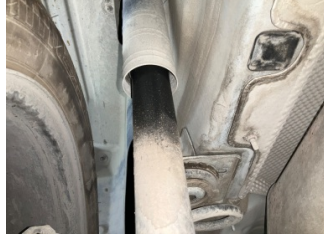
Arka aks, Amortisör, arka > Yağ Kaçağı
