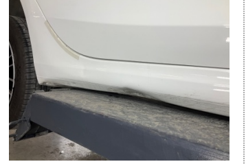
Marşbiyel, sağ, Marşbiyel, sağ > Hasarlı
