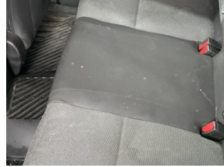
Döşemeler/Kapaklar, Döşemeler/Kapaklar > Yakıcı Madde ile Zarar Görmüş
