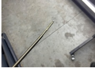
Motor, Yağ seviyesi > Eksik
