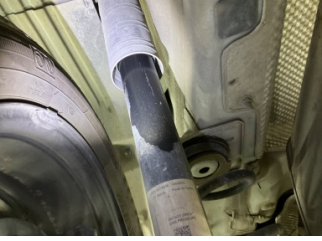
Arka aks, Amortisör körüğü, sol > Yağ Kaçağı
