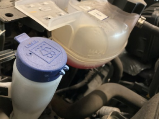
Motorsoğutması, Soğutma sıvısı > Eksik
