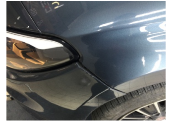
Tampon, ön, Ön tampon > Sabitlemesi Hatalı
