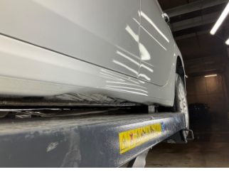
Marşbiyel, sol, Marşbiyel, sol > Hasarlı
