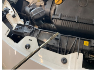
Motor, Yağ seviyesi > Eksik
