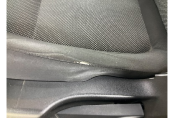
Koltuklar, ön, Koltuk, sol ön > Hasarlı
