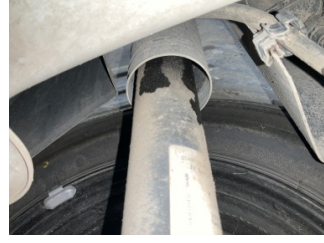
Arka aks, Amortisör, arka sağ > Yağ Kaçağı
