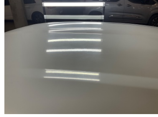
Tavan, Tavan > Dolu Hasarı
