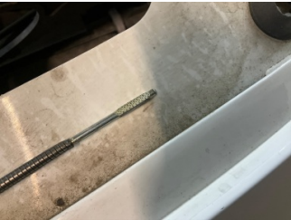
Motor, Yağ seviyesi > Eksik
