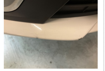
Tampon, ön, Ön tampon > Çatlak
