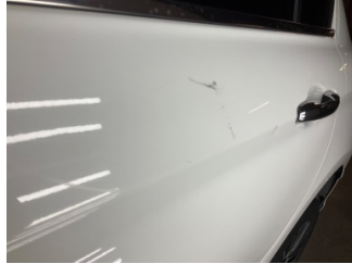
Kapı, sol arka, Kapı, sol arka > Çizik
