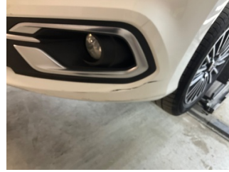
Tampon, ön, Ön tampon > Çatlak
