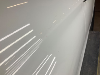
Kapı, sağ arka, Kapı, sağ arka > Çizik
