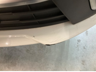
Tampon, ön, Ön tampon > Çatlak
