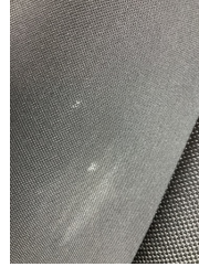
Koltuklar, ön, Koltuk arkılığı döşemesi, sağ ön > Yakıcı Madde ile Zarar Görmüş
