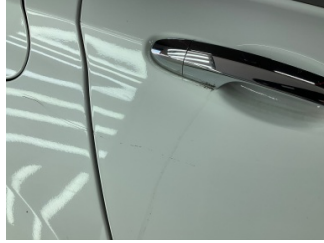
Kapı, sağ arka, Kapı, sağ arka > Çizik
