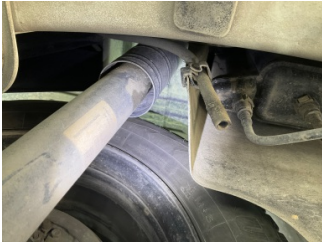
Arka aks, Amortisör, arka sağ > Sızdırıyor
