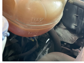
Motorsoğutması, Soğutma sıvısı > Eksik
