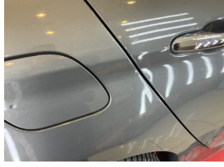
Çamurluk, sağ arka, Çamurluk, sağ arka > Ezik
