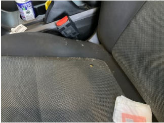
Döşemeler/Kapaklar, Döşemeler/Kapaklar > Yakıcı Madde ile Zarar Görmüş
