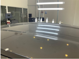
Tavan, Tavan > Dolu Hasarı
