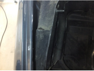
Kaporta, Sağ Kılıç Sacı > Standart Dışı Onarım
