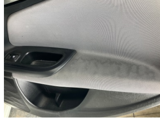
Döşemeler/Kapaklar, Döşemeler/Kapaklar > Deforme Olmuş
