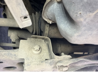
Ön aks, Aks mili, toz körüğü, sağ > Hasarlı
