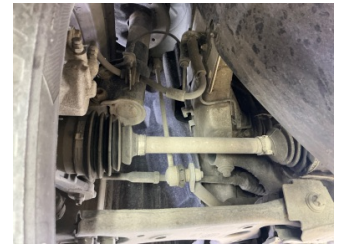
Ön aks, Denge çubuğu, bağlantı cubuğu sağ > Hasarlı
