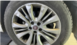
Jant, sağ ön > Deforme Olmuş
