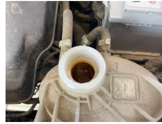
Motorsoğutması, Soğutma sıvısı > Kirlenmiş
