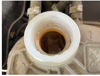
Motorsoğutması, Soğutma sıvısı > Eksik
