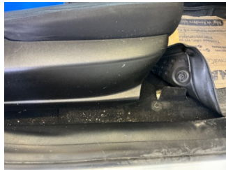
Döşemeler/Kapaklar, Döşemeler/Kapaklar > Yakıcı Madde Ile Zarar Görmüş
