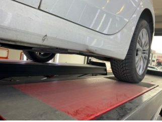
Marşbiyel, sol, Marşbiyel, sol > Hasarlı
