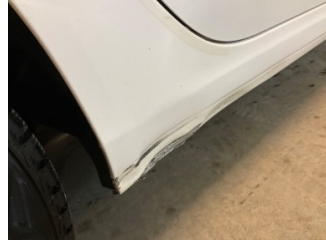
Marşbiyel, sağ, Marşbiyel, sağ > Hasarlı
