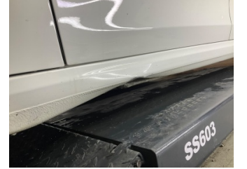
Marşbiyel, sol, Marşbiyel, sol > Hasarlı
