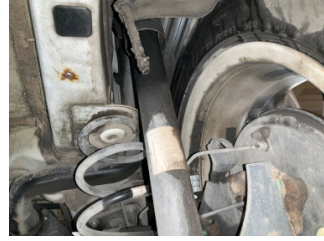
Arka aks, Amortisör, arka > Yağ Kaçağı
