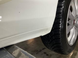
Marşbiyel, sol, Marşbiyel, sol > Hasarlı
