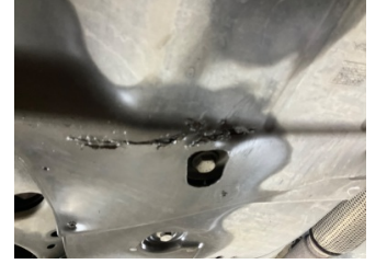
Motor, Alt muhafaza > Hasarlı
