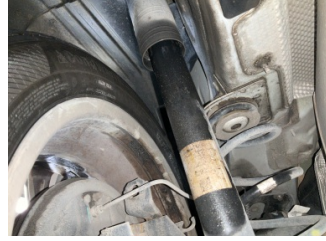
Arka aks, Amortisör, arka > Yağ Kaçağı
