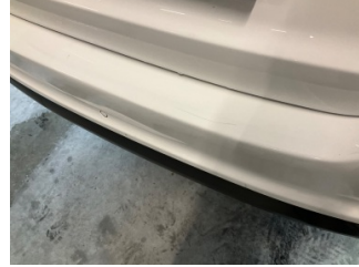
Tampon, arka, Arka tampon > Boyası Atmış
