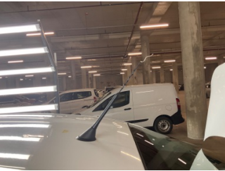
Komünikasyon/Navigasyon/EğlenceBagaj kapağı/kapısı, Bagaj sistemleri, Anten > Hasarlı
