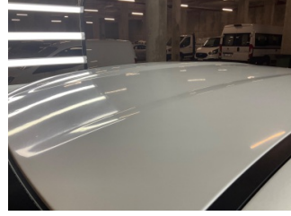
Tavan, Tavan > Dolu Hasarı
