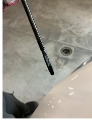
Motor, Yağ seviyesi > Eksik
