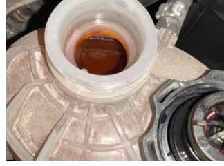
Motorsoğutması, Soğutma sıvısı > Kirlenmiş
