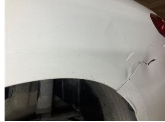
Çamurluk, sol arka, Çamurluk, sol arka > Hasarlı
