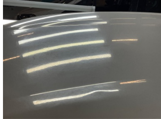
Tavan, Tavan > Dolu Hasarlı
