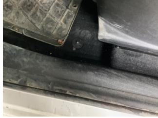
Döşemeler/Kapaklar, Döşemeler/Kapaklar > Yakıcı Madde Ile Zarar Görmüş
