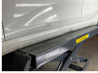
Marşbiyel, sol, Marşbiyel, sol > Hasarlı
