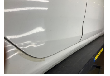
Kapı, sağ arka, Kapı, sağ arka > Ezik
