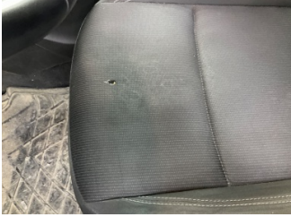
Döşemeler/Kapaklar, Döşemeler/Kapaklar > Yakıcı Madde Ile Zarar Görmüş
