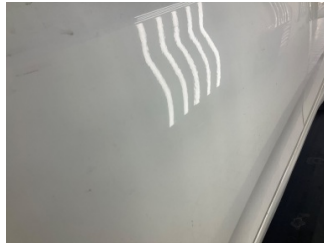
Kapı, sol ön, Kapı, sol > Ezik
