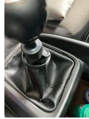
Şanzıman, Vites körüğü > Hasarlı
