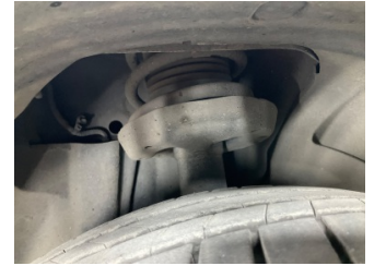
Ön aks, Amortisör körüğü, sağ > Deforme Olmuş
