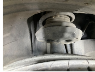
Ön aks, Amortisör körüğü, sol > Deforme Olmuş
