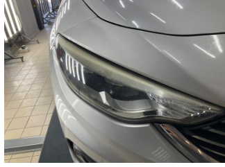
Farlar, Far camı, sağ > Deforme Olmuş
