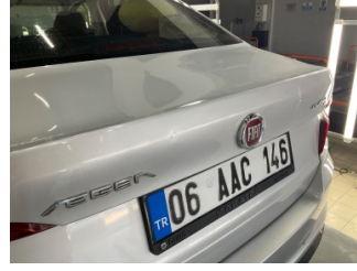
Bagaj kapağı/kapısı, Bagaj kapağı > Ezik
