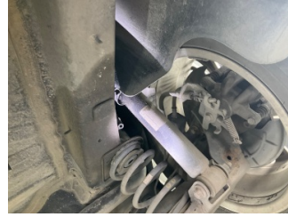
Arka aks, Amortisör, arka > Yağ Kaçağı
