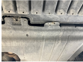
Motor, Alt muhafaza > Hasarlı
