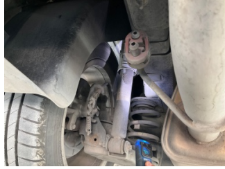
Arka aks, Amortisör, arka > Yağ Kaçağı
