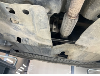
Motor, Alt muhafaza > Hasarlı
