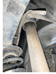
Arka aks, Amortisör, arka sağ > Yağ Kaçığı
