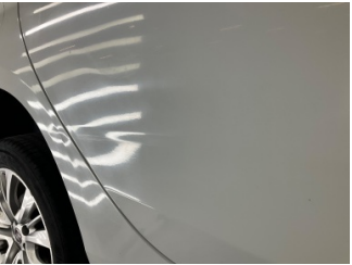
Kapı, sağ arka, Kapı, sağ arka > Ezik
