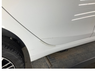
Kapı, sağ arka, Kapı, sağ arka > Çizik
