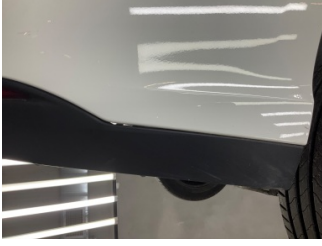
Tampon, arka, Spoiler > Sabitlemesi Hatalı
