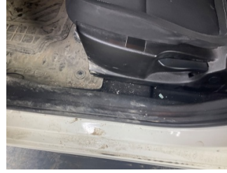
Döşemeler/Kapaklar, Döşemeler/Kapaklar > Yakıcı Madde İle Zarar Görmüş
