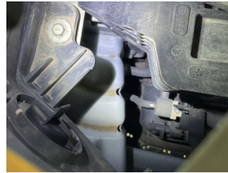
Tampon, ön, Bağlantı ayağı > Ezik
