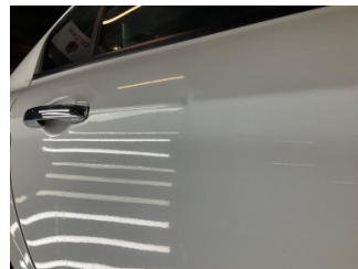
Kapı, sağ arka, Kapı, sağ arka > Ezik
