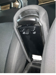
Döşemeler/Kapaklar, Kol dayaması, ön > Kırılmış
