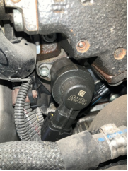
Motor, Motor/Yakıt sistemi > Sızdırıyor
