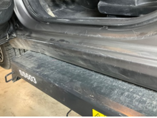
Marşbiyel, sol, Marşbiyel, sol > Hasarlı
