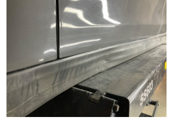
Marşbiyel, sol, Marşbiyel, sol > Hasarlı
