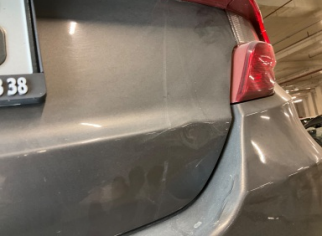
Bagaj kapağı/kapısı, Bagaj kapısı > Ezik
