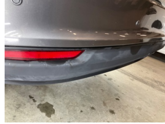
Tampon, arka, Spoiler > Deforme Olmuş
