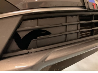
Tampon, ön, Ön tampon ızgarası > Hasarlı
