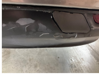
Tampon, arka, Spoiler > Çatlak
