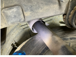
Arka aks, Amortisör, arka > Yağ Kaçağı
