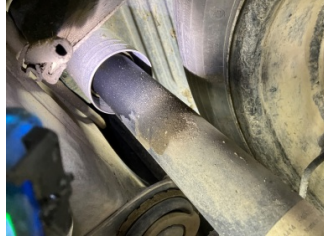
Arka aks, Amortisör, arka > Yağ Kaçağı
