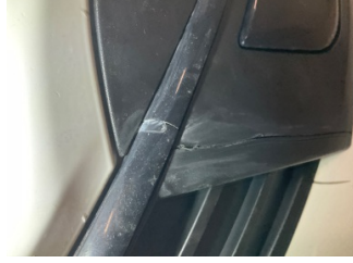
Tampon, ön, Ön tampon ızgarası > Kırılmış
