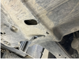
Motor, Alt muhafaza > Kırılmış
