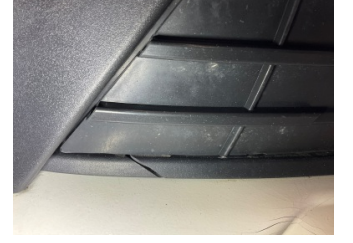
Tampon, ön, Ön tampon ızgarası > Kırılmış
