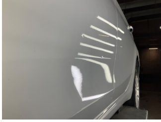
Kapı, sol ön, Kapı, sol ön > Ezik
