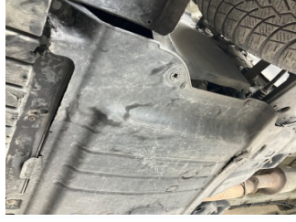
Motor, Alt muhafaza > Hasarlı
