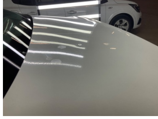
Bagaj kapağı/kapısı, Bagaj kapısı > Noktasal Ezik
