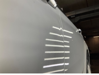
Kapı, sol ön, Kapı, sol ön > Ezik
