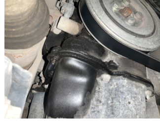
Motor, Motor > Yağ Kaçağı
