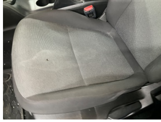
Döşemeler/Kapaklar, Döşemeler/Kapaklar > Yakıcı Madde Ile Zarar Görmüş
