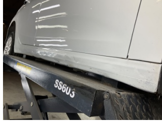
Marşbiyel, sağ, Marşbiyel, sağ > Hasarlı
