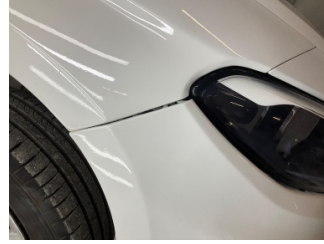
Tampon, ön, Ön tampon > Sabitlemesi Hatalı
