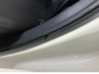
Kapı, sol arka, Kapı fitili > Hasarlı
