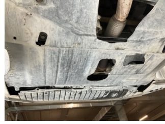
Motor, Alt muhafaza > Hasarlı
