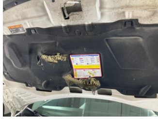
Motor, Motor izolasyonu > Hasarlı
