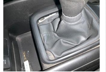
Şanzıman, Vites körüğü > Hasarlı
