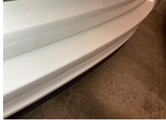
Tampon, arka, Arka tampon > Küçük Çizik
