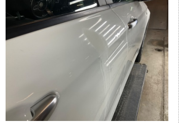
Kapı, sağ arka, Kapı, sağ arka > Deforme Olmuş
