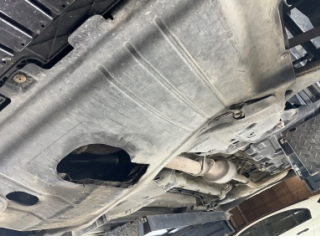
Motor, Alt muhafaza > Hasarlı
