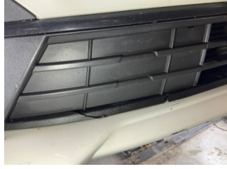
Tampon, ön, Ön tampon ızgarası > Hasarlı
