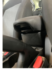
Döşemeler/Kapaklar, Kol dayaması, ön > Sabitlemesi Hatalı
