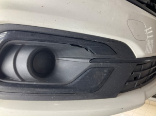
Sis lambaları, Sis Işgarası Sağ > Hasarlı
