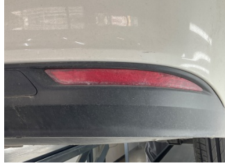
Tampon, arka, Reflektör, sağ > Çatlak
